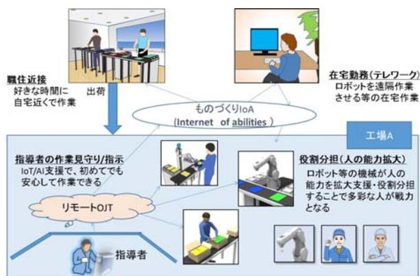
補足図2-1 ものづくりIoAによる人-機械能力拡張型生産システム
