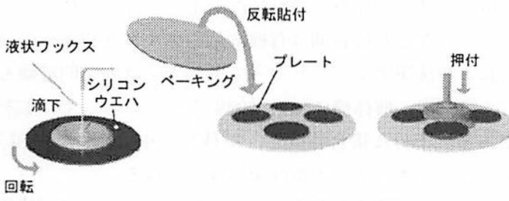
図 2.2.1 シリコンウェハ研磨工程における接着剤の使用<sup>2)</sup>
