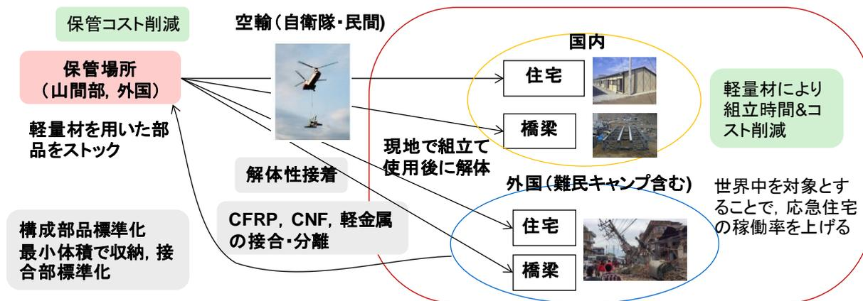
図 A2.3.1 応急住宅のリユースのしくみ
