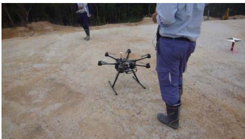
図 12 : ドローンによる土量計測 (出典 : (株)パスコ)
