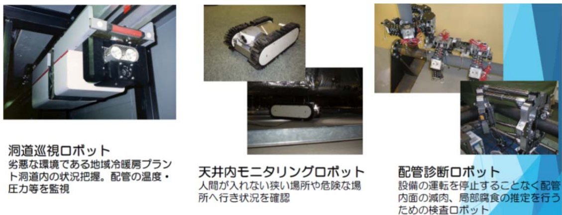
図 12：既開発のモニタリングロボット（出典：新菱冷熱工業(株)）
