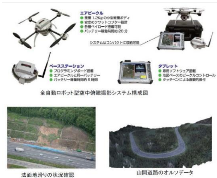
図 29 マルチコプターを使用した土砂崩落の把握システムのイメージ
