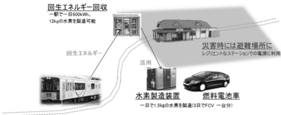
図2.1.3-1 水素製造装置を中心としたローカルコミュニティ
