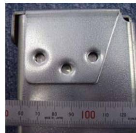
図3. 1. 5 薄板構造で利用されるかしめ（クリンチ）
