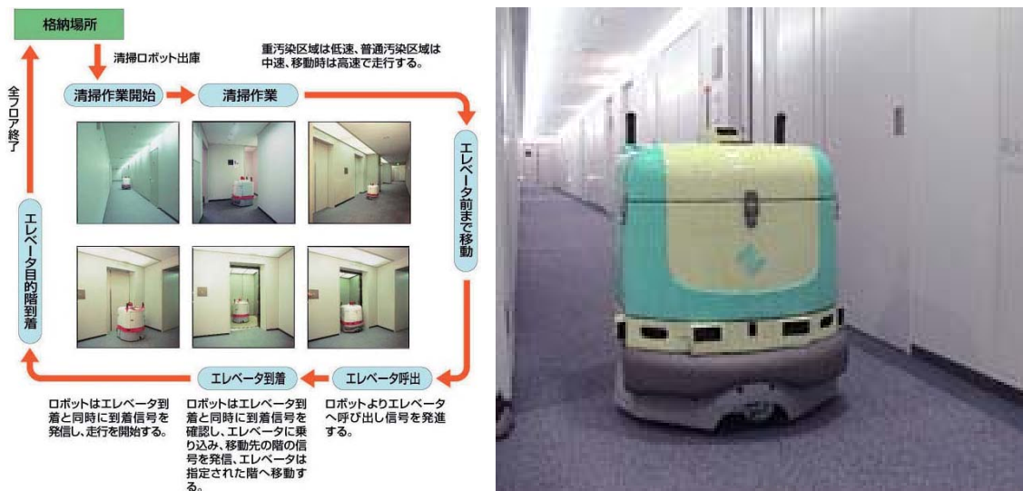
図5. 1. 2. 1. 6 エレベータ連動型ビル清掃ロボット (出典 ロボット大賞 2006 アーカイブ)
