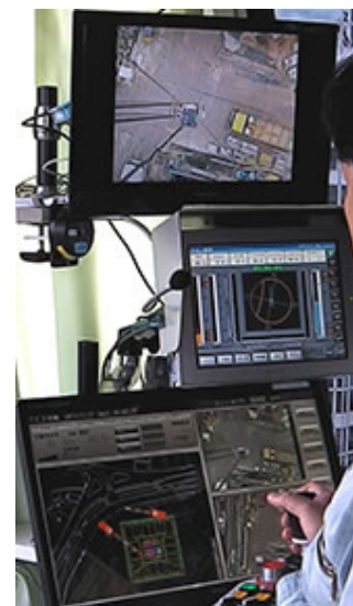
図5. 1. 2. 1. 3 (a)多機能フック (b)運転室内モニター (出典 清水建設株式会社 HP)
