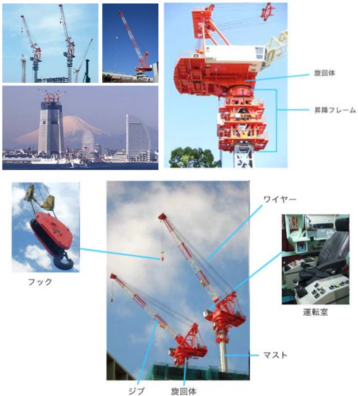
図5. 1. 2. 1. 1 タワークレーン及び各部名称（出典 IHI 運搬機械株式会社 HP）
