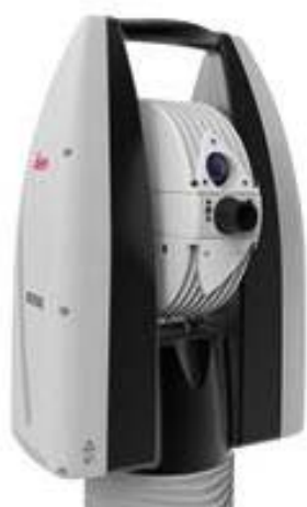
図5. 2. 2. 4 レーザ式トラッキングシステムの例（出典 ライカ社 HP）
