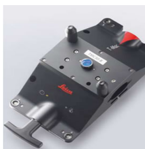
図5. 2. 2. 4 レーザ式トラッキングシステムの例（出典 ライカ社 HP）
