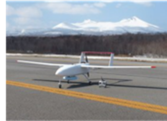
放射線モニタリング無人機(ベース機)外観 (JAXA殿HPより)
