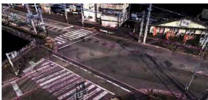
MMSIによる3次元点群データ
