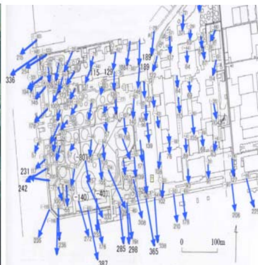
阪神大震災時の神戸港の液状化・護岸側方流動の教訓（護岸が沖合に流れ、神戸港の物流機能にダメージを与えた） 早稲田大学 濱田政則教授資料より
