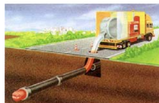
＜圧力管更生ロボット＞
