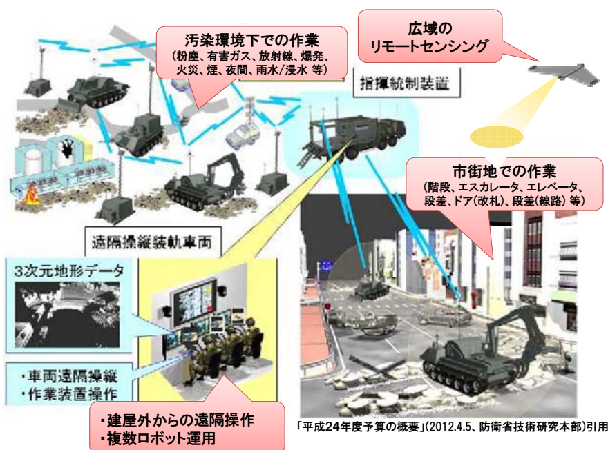
図4. 6 市街地での運用・試験概念図
