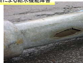
(B) 管路破断による給水機能障害
