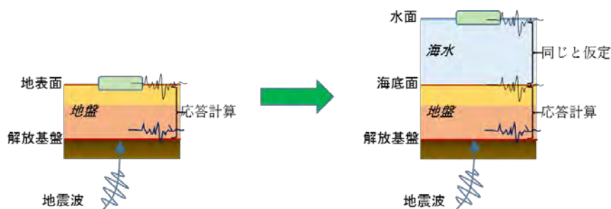
図 14 地表面（左）と水面（右）に設置された原子力発電所に地震波が届くまでの概念図
