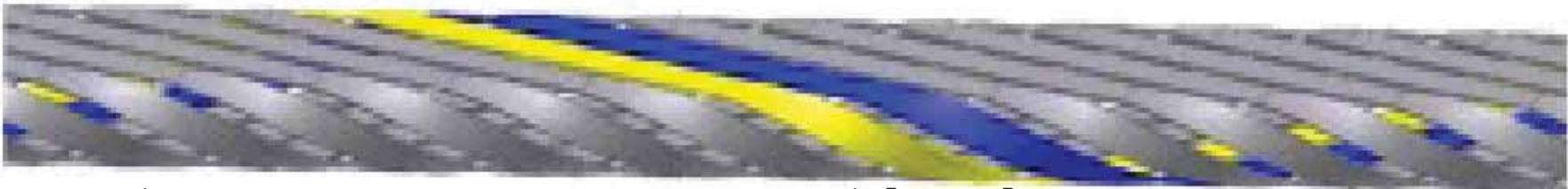
CCRC(Coated Conductor Rutherford Cable) [AC16] : ロエベルケーブルをサブケーブルとしたラザフォードケーブルの概念図
